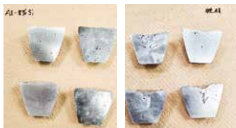
減圧凝固断面図、 エッチング処理有と 処理無写真
