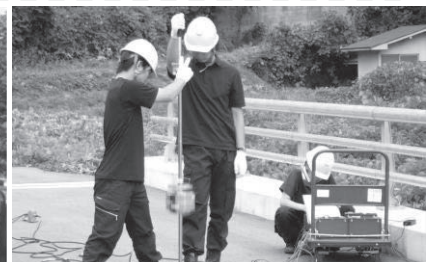
FWDを用いた橋梁の健全性調査
